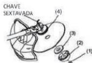
Insira a chave hexagonal através do orifício da caixa da engrenagem e rode a arruela de recepção (4), ate travar- afrouxe a porca (1) com chave de encaixe, remova a porca (1), copo(2) e arruela(3)
