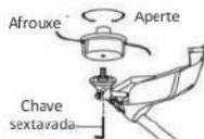
A porca (1), Arruela (3) e o copo (2) não são necessários, o cabeçote deve ir acima da arruela de recepção (4). Insira a chave hexagonal através do orifício da caixa da engrenagem e rode a arruela de recepção (4), até travar, em seguida parafuse o cabeçote de corte de náilon no eixo girando-o no sentido anti-horário, remova a chave hexagonal.
