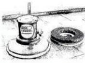
Para limpar o equipamento, certifique-se que a chave liga-desliga esteja na posição "0" (desligado) e retire o plugue da tomada. Na limpeza, use apenas um pano macio levemente umedecido em água, secando em seguida. Enrole o cabo de alimentação elétrica nos cabos e guarde o equipamento em local seco. Não deixe suportes ou escovas sob o equipamento. Sequede e guarde à parte.
