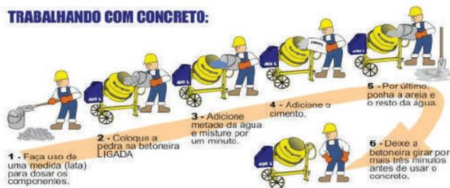
Uma betoneira ou misturador de concreto é o equipamento utilizado para mistura de materiais, na qual se adicionam cargas de pedra, areia, cimento e água, na proporção e textura devida, de acordo com o tipo de obra.
